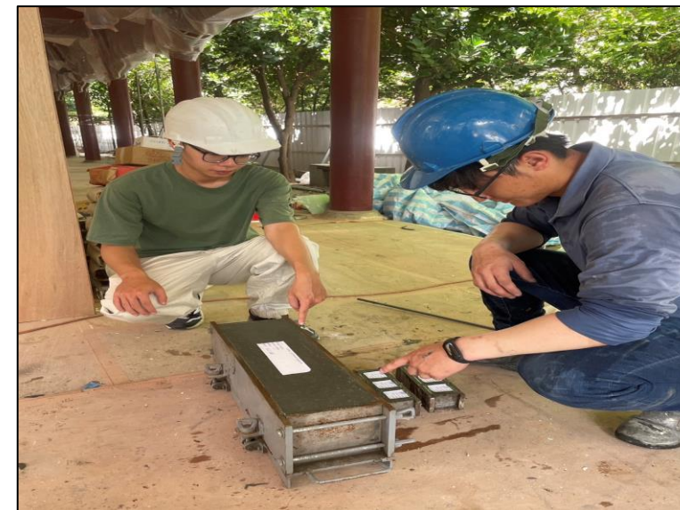
步驟4-2.UHPC試體取樣
