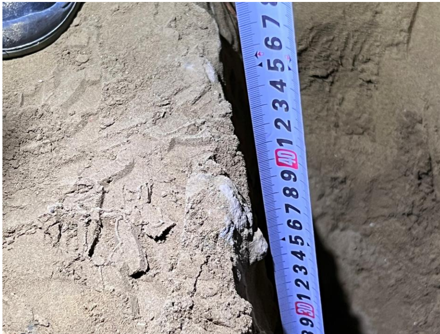
開挖深度至板頂約40cm 扣除鵝卵石層10cm 推測版厚約30cm
