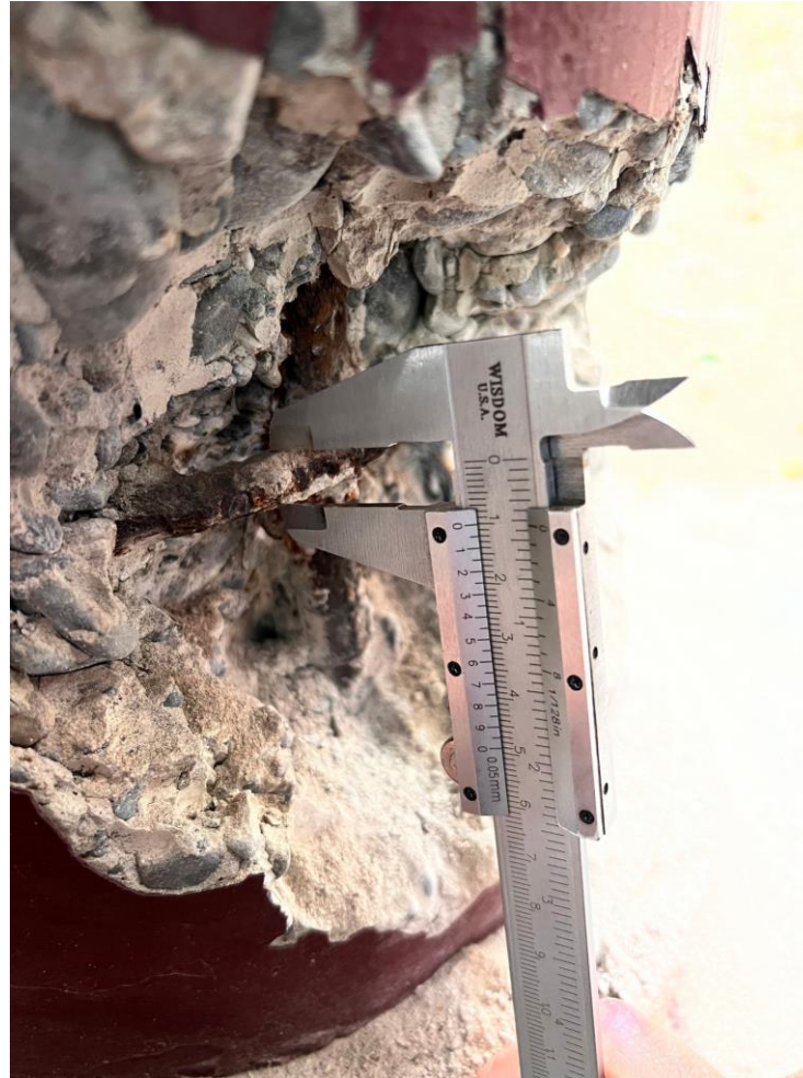
箍筋直徑約1cm 推測為D10(#3)
