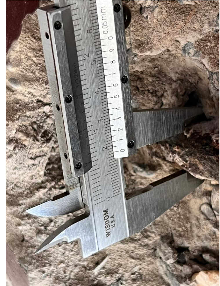
主筋直徑約1.6cm 推測為D16(#5) 46
