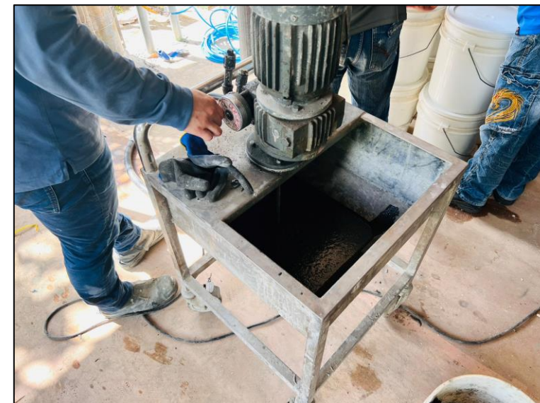
步驟4-3a.人工攪拌壓送機
