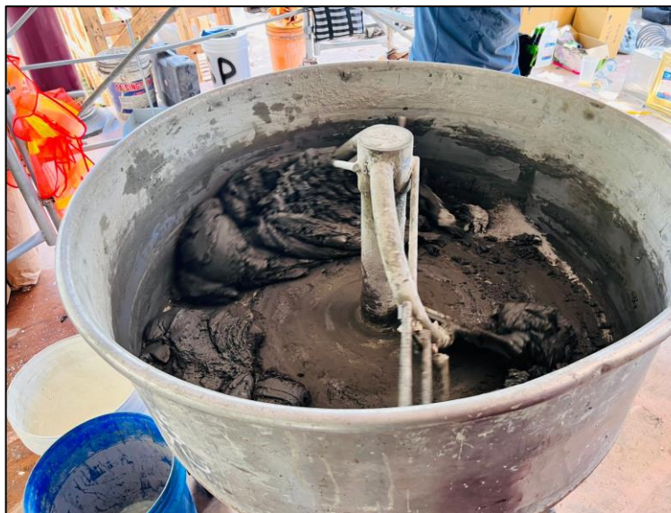
步驟4-1.UHPC攪拌中(補含纖維照)
