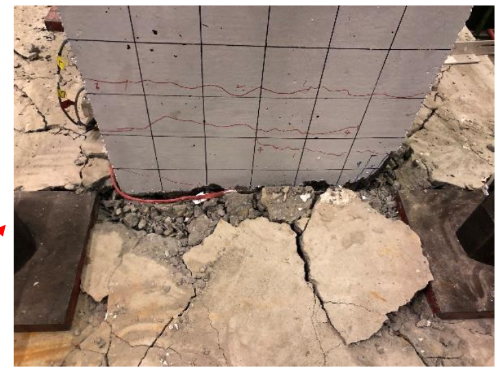
外加構架側基礎 植筋握裹破壞
