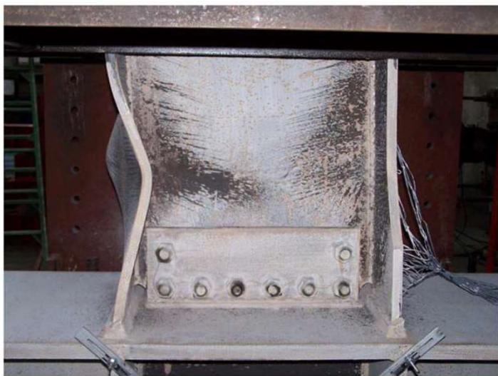
試體WF6-1在5%轉角時於翼板發生明顯挫屈
