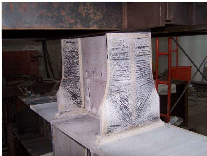
試體WF6-1在3%轉角時於梁翼上呈現石灰脫落
